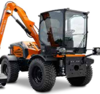
Il braccio **T** è stato progettato per lavorare con una estensione fino a 6,7 metri e di raggiungere una altezza massima di 8,6 metri. La sua particolare geometria ne esalta le caratteristiche per lavori di manutenzione stradale ove si desidera un connubio tra sfalcio a bordo strada e lavori di rifinitura in profondità. Il robusto sfiolo telescopico del modello **T6.5** permette una maggiore agilità di lavoro e la massima performance anche in situazioni difficili.
