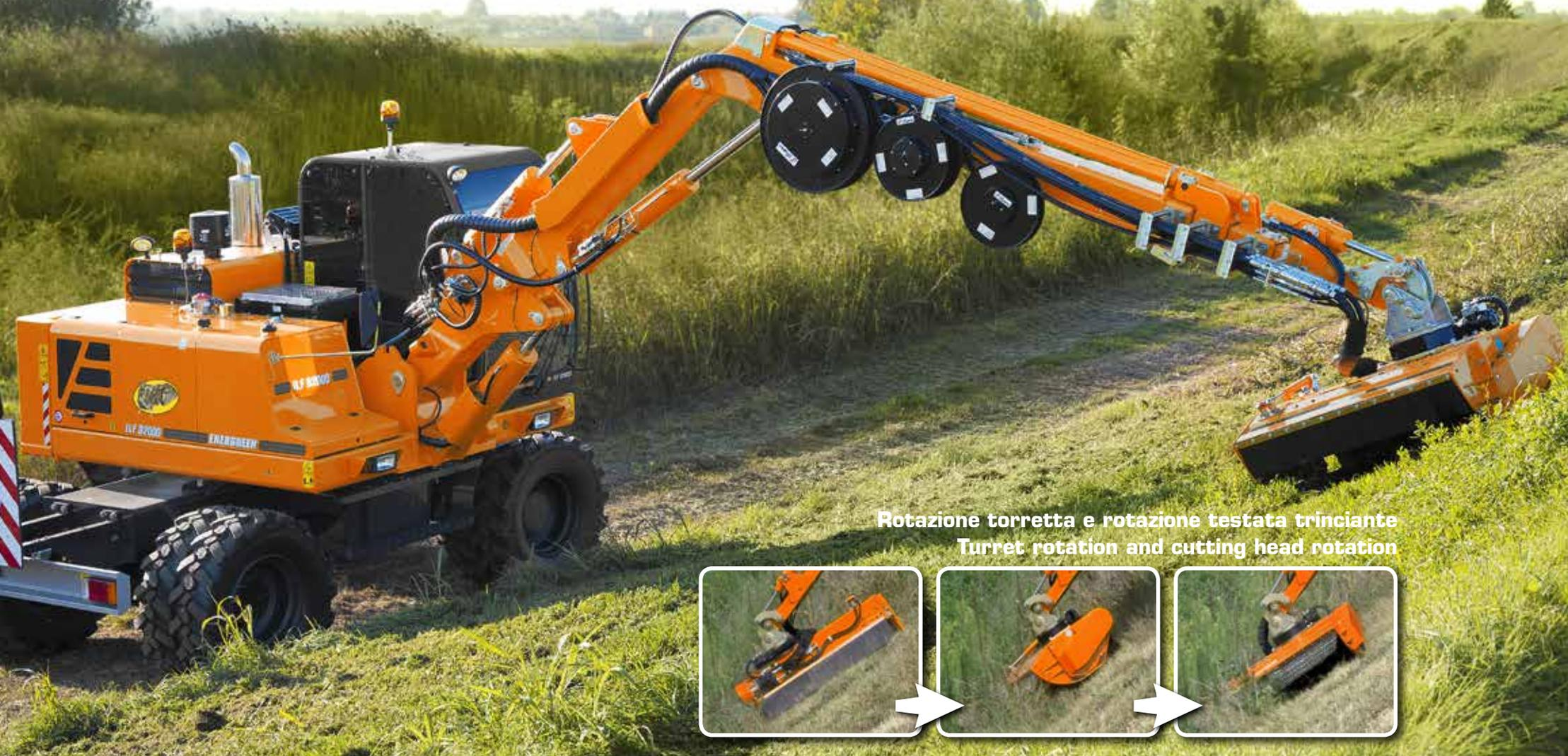
Rotazione torretta e rotazione testata trinciante
